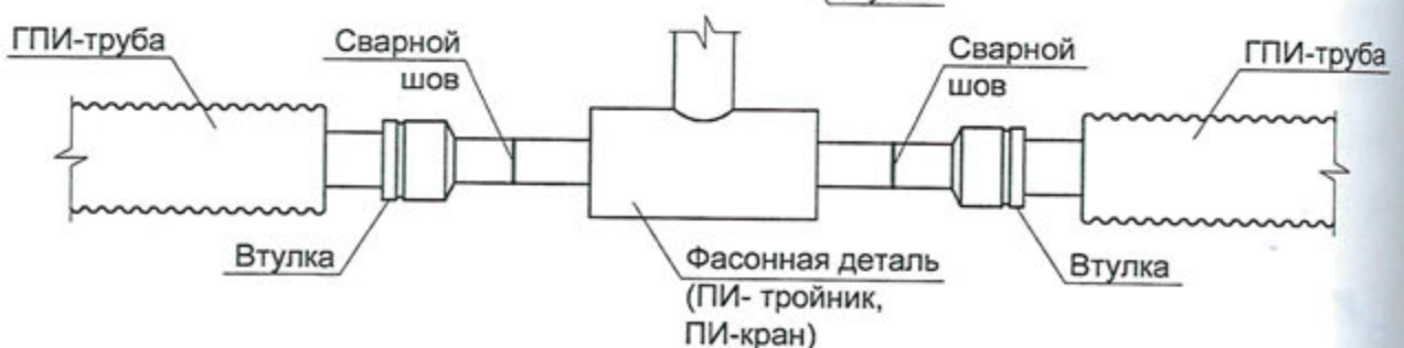
Рисунок 4.7 – Варианты соединения ГПИ-трубы с установкой втулки
