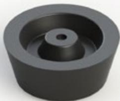
**Назначение:** пробка монтажная применяется для герметизации заливочных отверстий в термоусаживаемых муфтах при изоляции стыка. Вплавляется в термоусадочную муфту после заливки смеси компонентов пенополиуретана.
