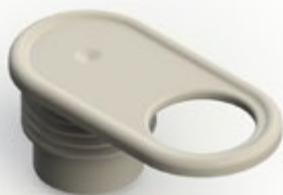
**Назначение:** пробка обезвоздушиватель применяется для стравливания воздуха из термоусаживаемой муфты после заливки смеси компонентов пенополиуретана. После окончания реакции смеси компонентов, извлекается и заменяется на пробку монтажную.
